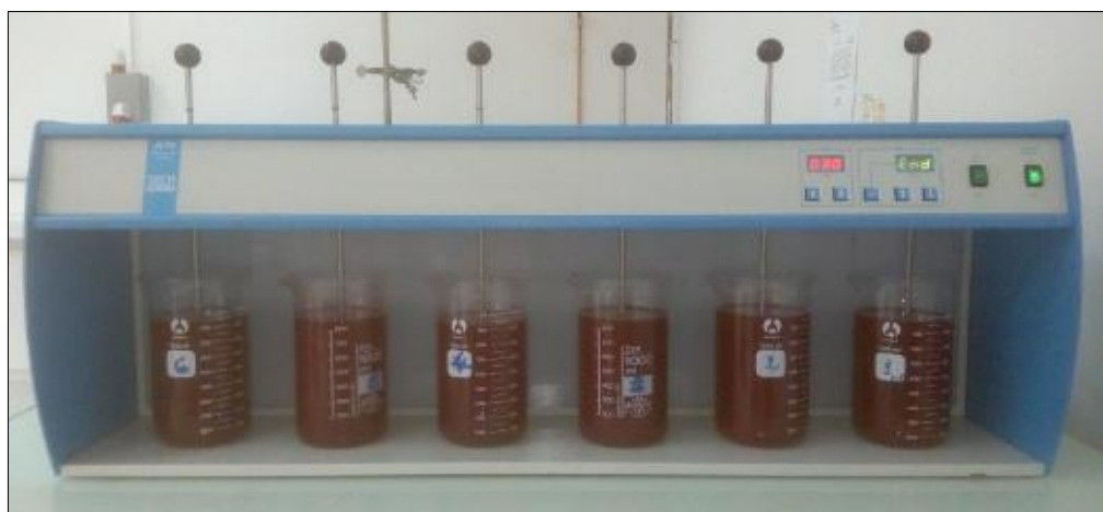
Fig. II.1 : Appareil du Jar test
